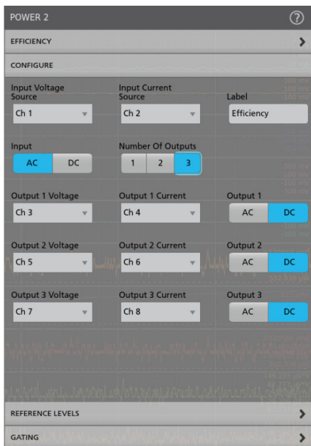
図11: 複数の電力変換デバイス (AC-DC、AC-AC、DC-DC、DC-AC) をテストするための効率測定設定
