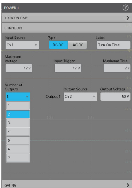
図 14: ターン・オン時間測定の設定画面は複数の出力デバイスに対応している
