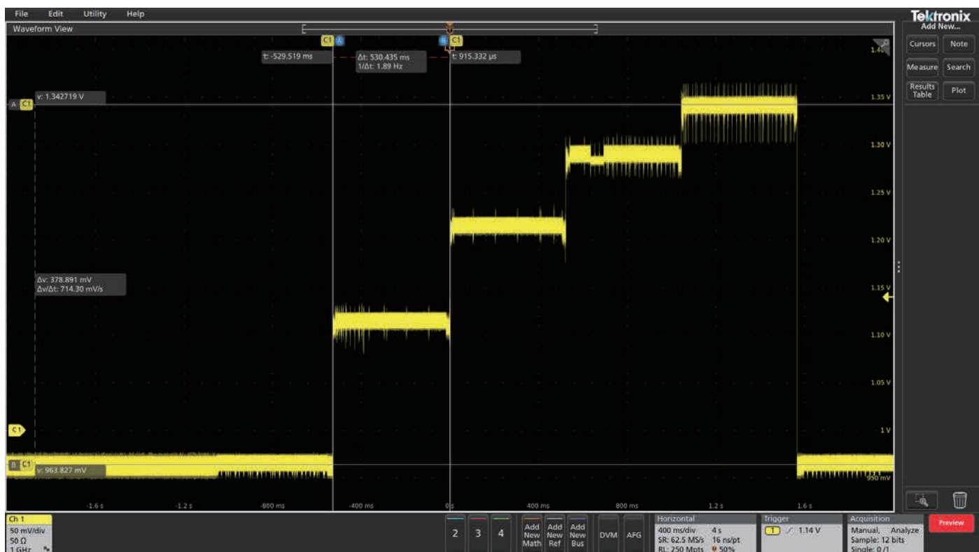
図11. 周波数が上がると、必要に応じて入力電圧が変化するデバイスの例。多くのACカップリング・フィルタでは、ステップ間の約2Hzの周波数成分が見落とされる。
