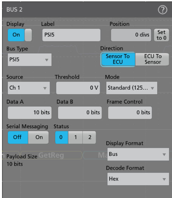
図 39: PSI5 (センサ-ECU) のコンフィグレーション
