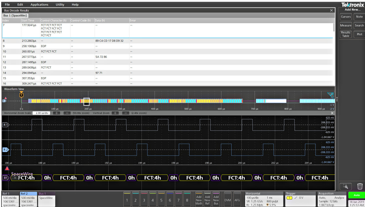
図 32: プロトコルのデコード結果表の例。SpaceWire バスで取り込まれたすべてのパケットが、タイムスタンプ付きの表形式で表示されている
