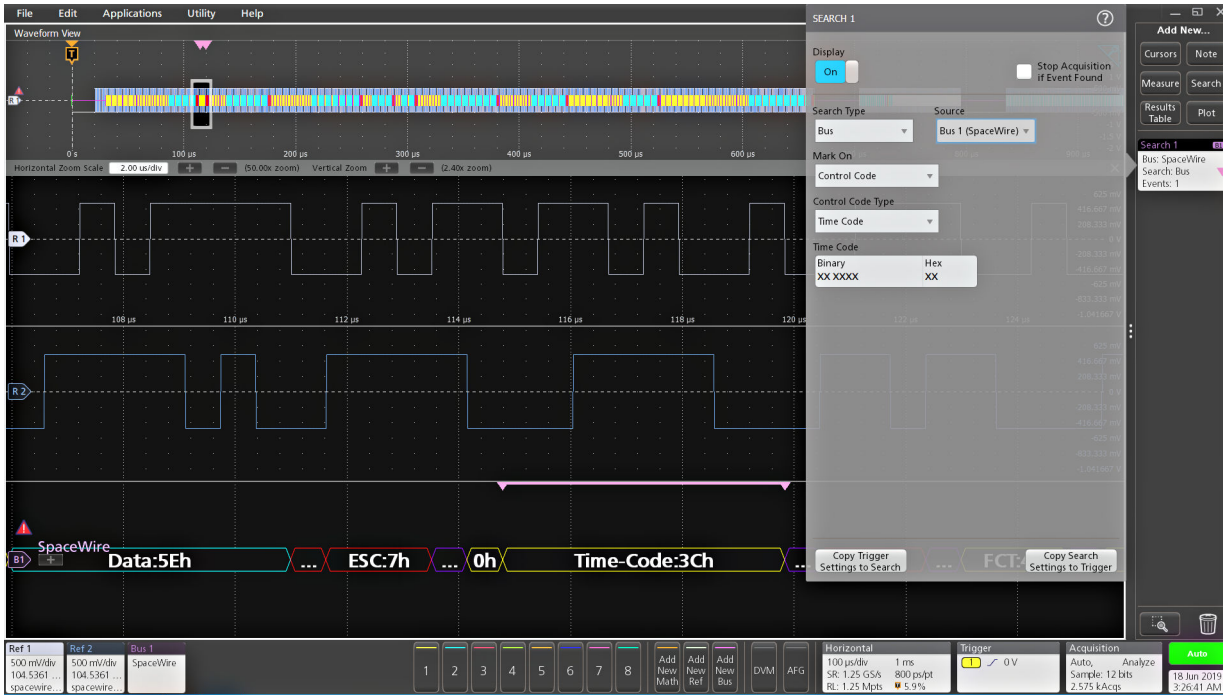
図 31: SpaceWire バスで特定のデータ・パターンでサーチした例。シンクで自動的にサーチされている
