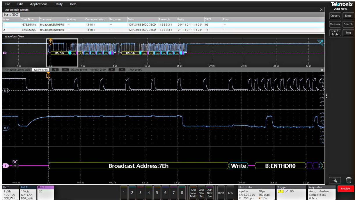
図5: プロトコルのデコード結果表の例。I2Cバスで取り込まれたすべてのパケットが、タイムスタンプ付きの表形式で表示されている
