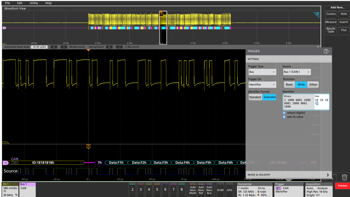
図 10: CAN バスの特定の拡張識別子の値にトリガした例
