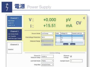
多チャンネル電源を、バイアスまたはリスト・スイープ・モードで個別にチャンネル制御が可能
