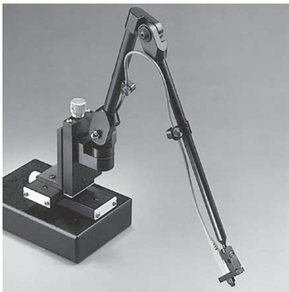
図2-11. ハイブリッド回路やICのような小型形状デバイスをプロービングするためのプロービング・ステーションの例
