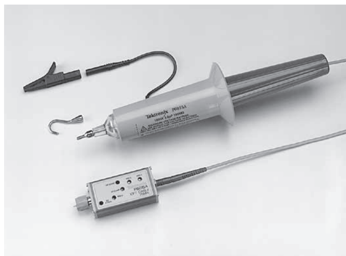
図2-5. P6015A型は、20kVまでの直流 (DC) 電圧と75MHzの周波数帯域で40kVまでのパルス測定することができます。
