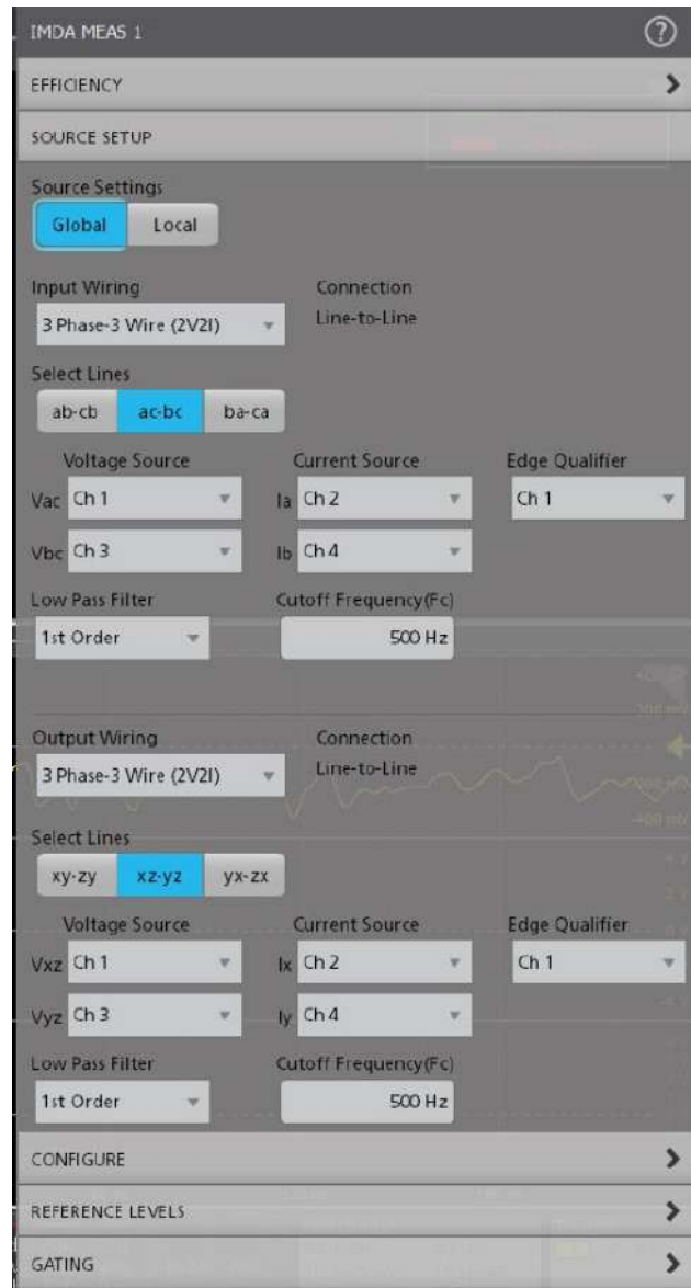
圖 32：使用 5/6 系列 MSO 示波器設定三線輸入和三線輸出以進行效率量測的設定。
