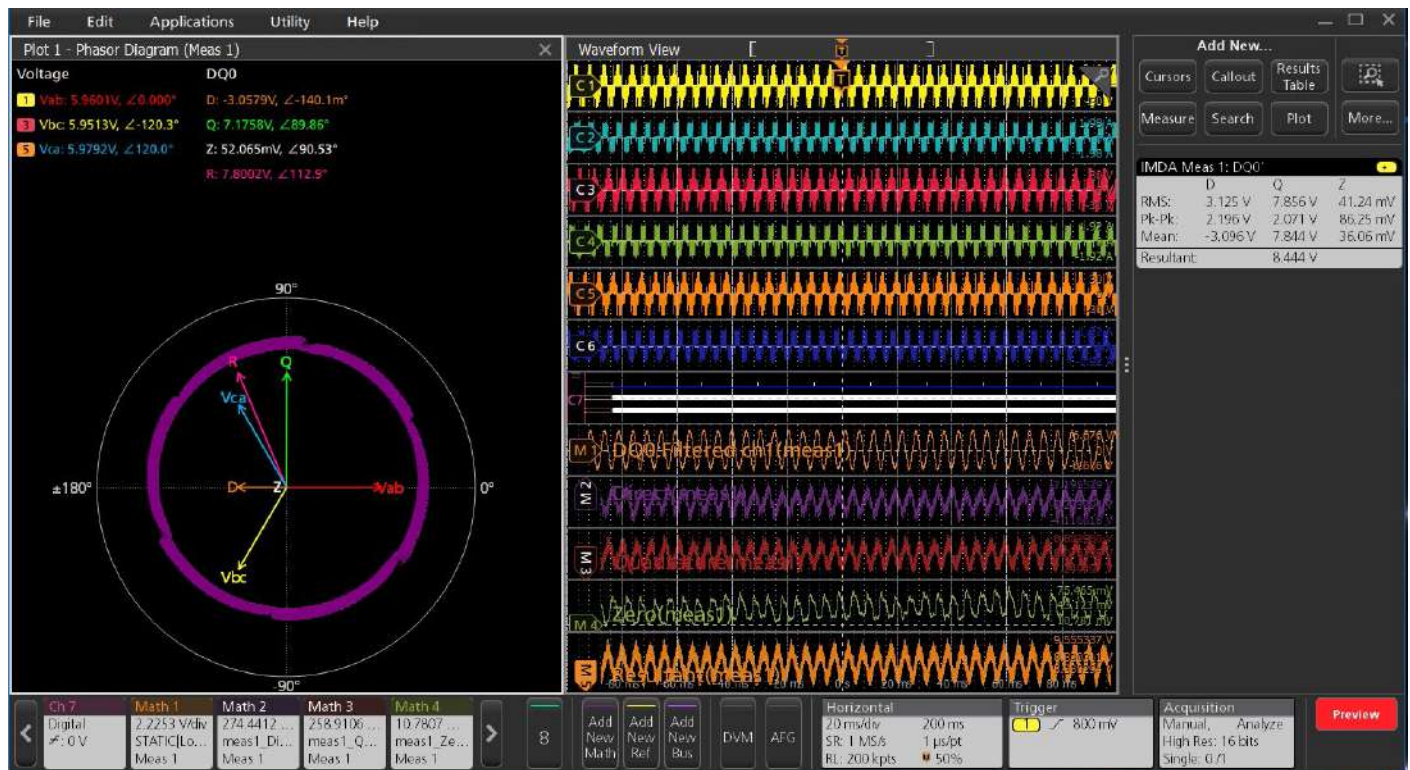
圖 27：DQ0 相量圖，顯示 D 向量、Q 向量和合成向量 (R)，馬達速度和方向回饋則由正交編碼器感應器提供。
