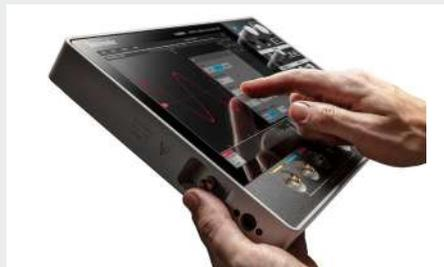
直觀的 10.1 英寸電容式彩色觸控式螢幕採用簡化的使用者介面，可快速存取任何功能。
