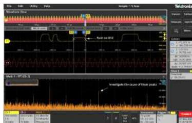
具有 36 種自動量測、進階數學、附閘控的 FFT、搜尋和標記、限制和眼圖遮罩的綜合分析功能。
