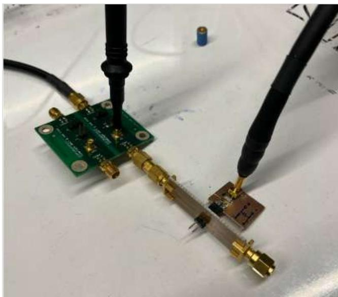
透過多極點設計和更精確的分流行為建模，可以進一步改進。如您所料，濾波板本身也存在寄生元件，這些元件也必須進行補償，形成一個收益遞減的無限循環。在 280 MHz 以上的 VNA 資料中可以看到寄生元件，此時分流器加濾波器的反應恢復到強烈電感狀態。
